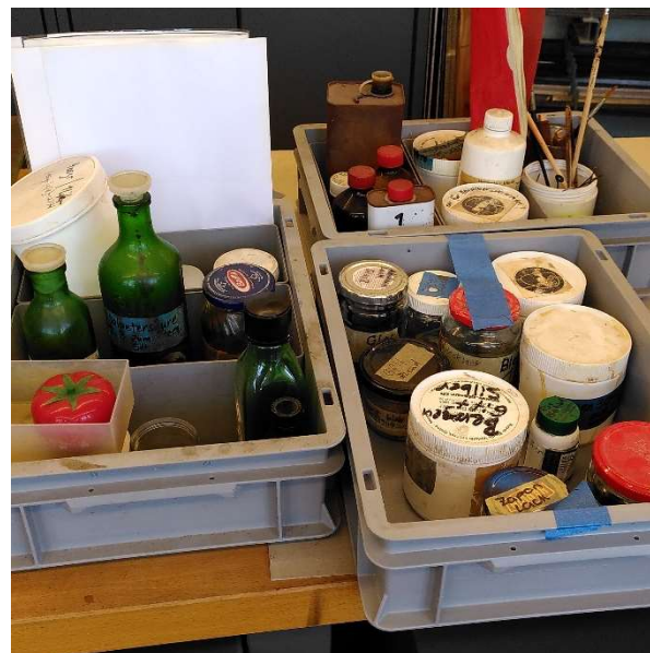
Abb. 39: Eine Sammlung gemischter Chemikalien aus dem Bereich Werken. Die Beschriftung/Kennzeichnung wie auch die Art der Behälter sind mehrheitlich ungenügend.
