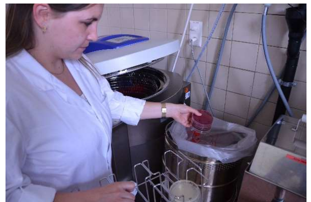
Abb. 13: Nach dem Auszählen werden die bewachsenen Agarplatten separat gesammelt und anschliessend im Autoklav unter hoher Hitze und Druck dekontaminiert. So gelangen keine Bakterien, welche im Labor gewachsen sind, in die Umwelt.
