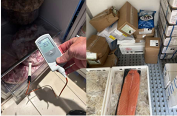
Abb. 17+18: Deutlich zu hohe Temperatur im Kühlschrank und aufgetaute Lebensmittel im defekten Kühlwagen.
