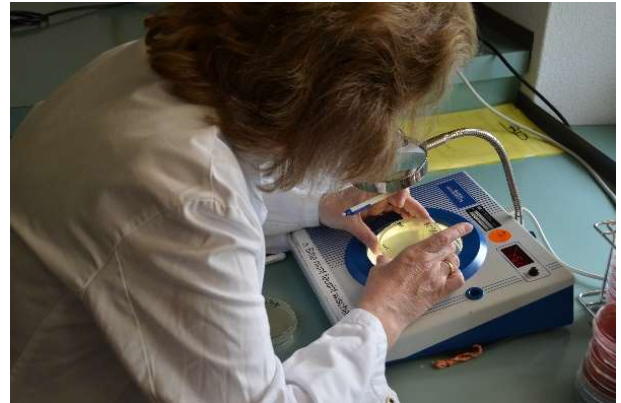
Abb. 12: Der Colony-Counter hat eine Lupe und Beleuchtung von unten. Dadurch wird das Auszählen der kleinen Kolonien für die Laborantin einfacher.
